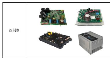
适用于家用及商用变频空调、工业及 轨道交通变频空调、新能源大巴变频 空调、压缩机控制器等。具有智能控 制,无级变速,高效节能,噪音低, 过流、过压、过载保护等特点。
